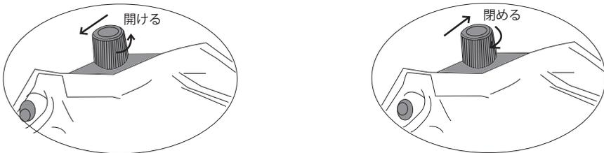
本体を平らな場所に置き、反時計回りにバルブを回すと、マット内部のクッション材の反発力により自動的に空気が入ります。約10~15分経過するとマットに空気が入った状態になりますのでバルブを時計回りに回しながら閉めれば使用可能です。空気口を閉める際はバルブの目印と本体の目印が合っているか確認してください。バルブの閉めすぎはバルブ本体を破損する原因となりますので注意してください。
