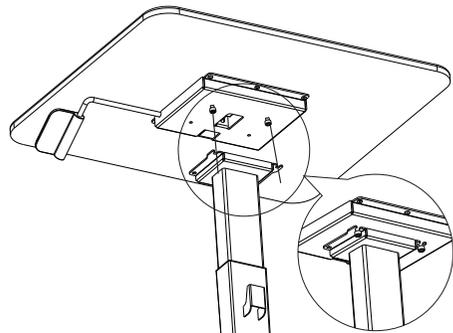
⑥ 六角レンチで仮止めしたネジを固定します。
