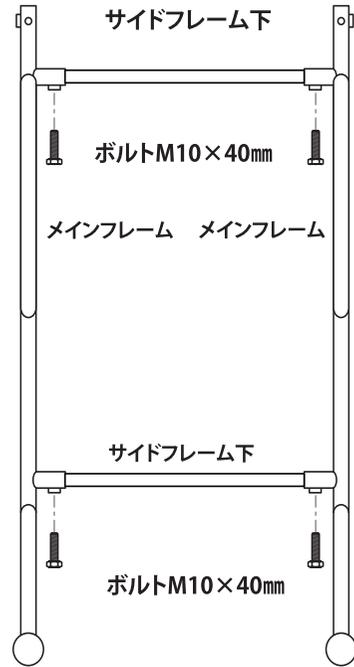
差し込んだサイドフレーム下を、ボルトM10×40mmで仮止めし、【フレーム下ASSY】を組立ます。
