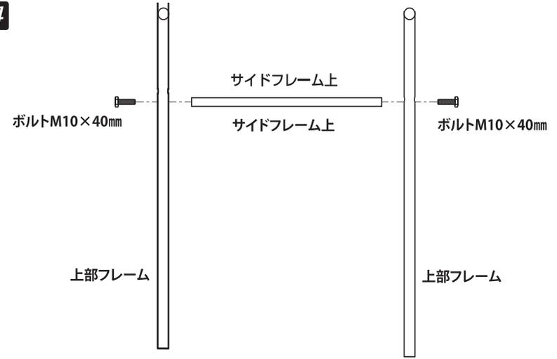
上部フレーム左右に、サイドフレーム上をボルトM10×40mmで仮止めします。
