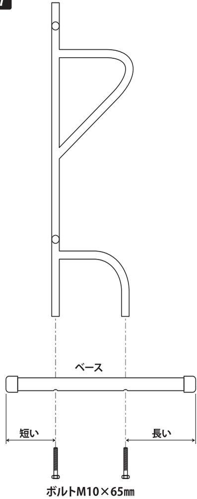
ベースのボルト取付位置に注意し、図のようにメインフレームとベースをボルトM10×65mmで仮止めします。
