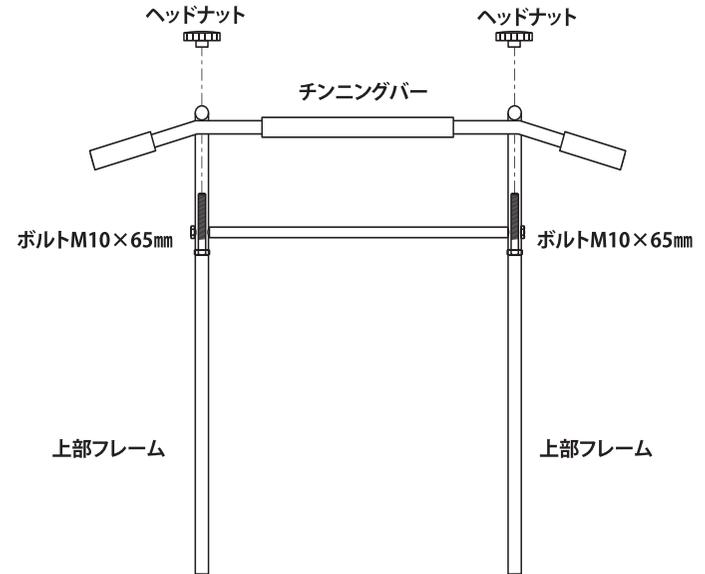
チンニングバーを上部フレームに、ボルトM10×65mmとヘッドナットで取り付け、【フレーム上ASSY】を組立ます。
